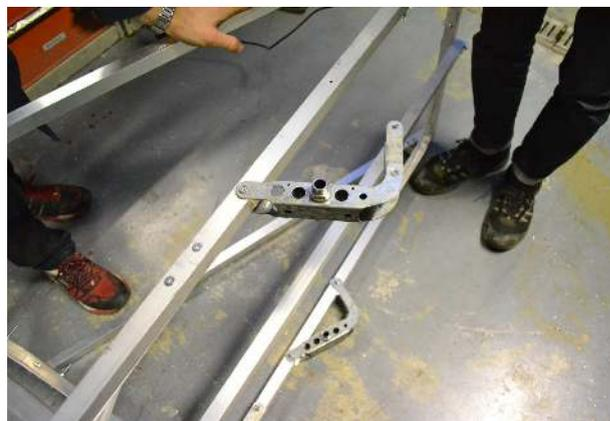
**8/ Renforcement fixation barre de tirage (barres de 5 cm)**
